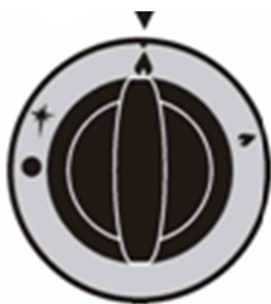
rys 24. Położenie pokrętki na płomień maksymalny
