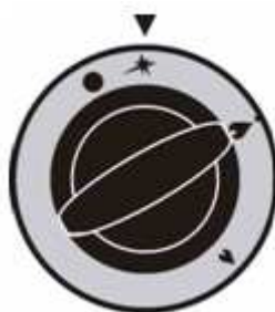
rys 23. Położenie pokrętki podczas zapalania palnika pilotującego
