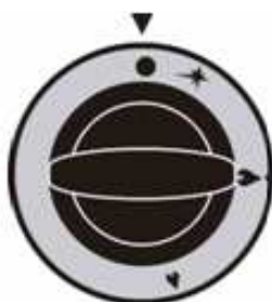
rys 26. Położenie pokrętki w pozycji „kurek gazowy zamknięty”
