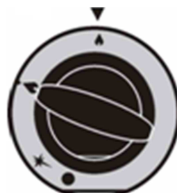
rys 25. Położenie pokrętki na płomień minimalny
