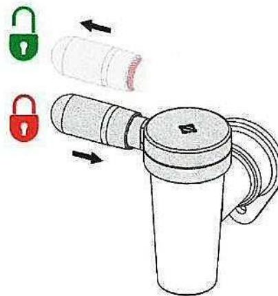
rys 22. Widok na zawór spustowy strawy w pozycji zamkniętej
