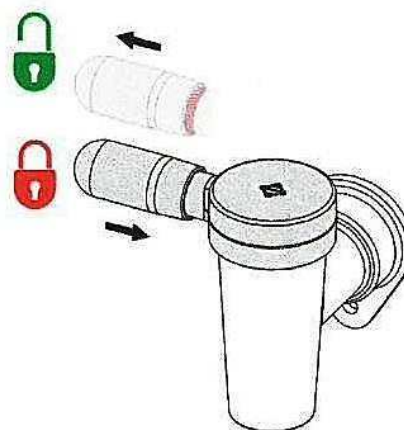
rys 16. Widok na zawór spustowy stawy w pozycji zamkniętej
